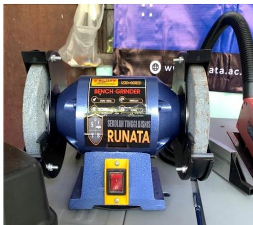
Gambar 11 Mesin Amplas Bulat
